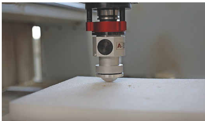
/ Mit einem Messer, das in das Atemag-Soft-Cutter-Pro-Aggregat eingespannt ist, lässt sich unter anderem Schaumstoff problemlos schneiden.
