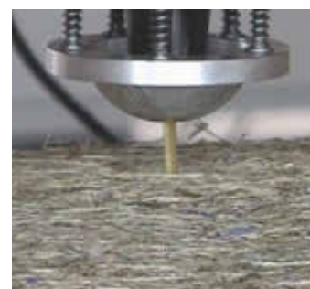
/ Mit oszillierenden Bewegungen lassen sich z. B. auch Dämmungen schneiden.
