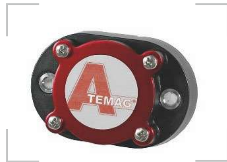
/ Die Erfassungs-Chips werten die Daten per integriertem Prozessor direkt aus und leiten sie dann weiter.
