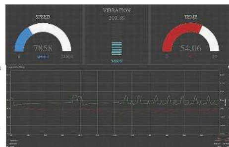
/ Alles im Blick: Die Sensoren erfassen Temperaturen, Vibrationen, Drehzahlen und Laufzeiten.
