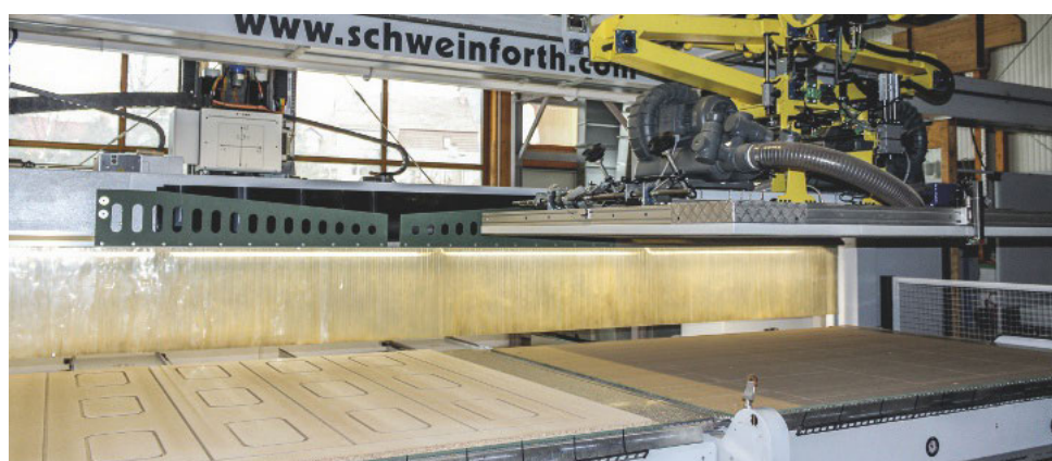
Der Saugheber erlaubt den Wechselbetrieb und das Picken für das Komplettbearbeiten
