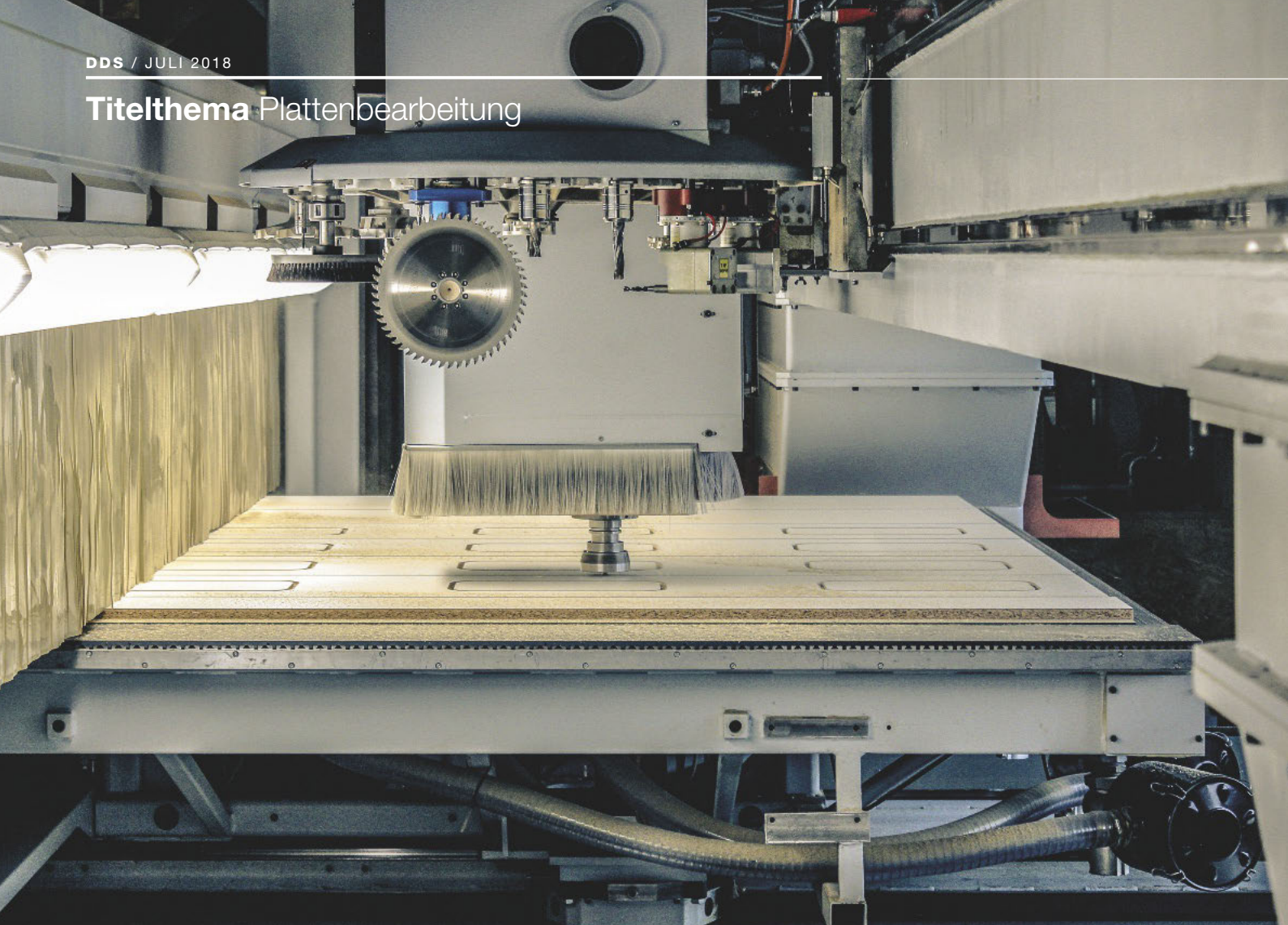
2 mm Material bleiben unter der Nut stehen, damit das Vakuum nicht entweicht. Das Ausfräsen danach erfolgt mit geringer Schnittkraft
