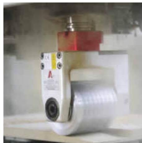
/ Hobelwellenaggregate erweitern das Spektrum von Bearbeitungszentren, besonders von 5-Achs-Maschinen.
