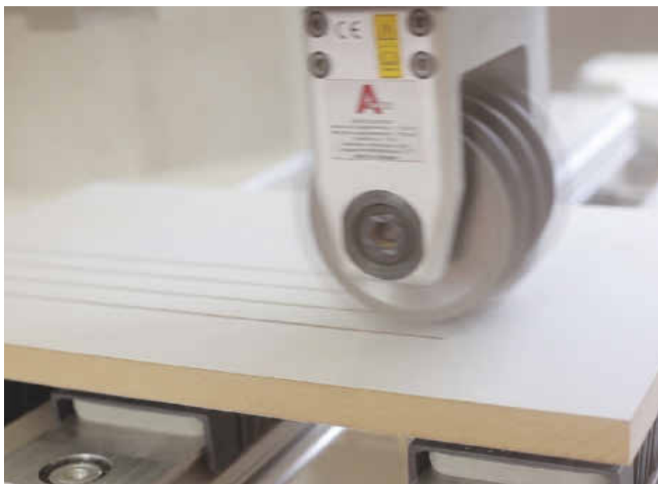
/ Der Mega Cutter von Atemag: Er ist für den Einsatz eines Hobelmessers oder eines Sägepaketes bei Nutzung des optimalen Drehmoments der Motorspindel und optimaler Werkzeugdrehzahl geeignet.
