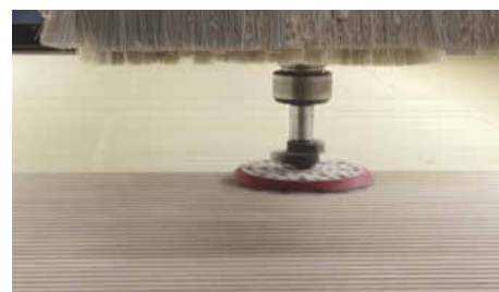
/ Schleif- und Polierbearbeitungen auf der CNC übernimmt zuverlässig der Soft Grinder von Atemag.
