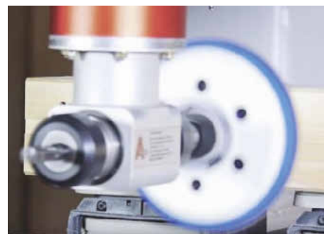
/ Den Soft Grinder gibt es in der Smart Line von Atemag auch in Kombination mit einem Winkelaggregat.
