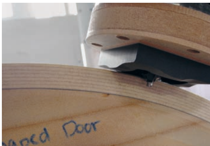
1 und 2: Das Tastaggregat fräst Radien in die Kanten der geschwungenen Formholzteile
