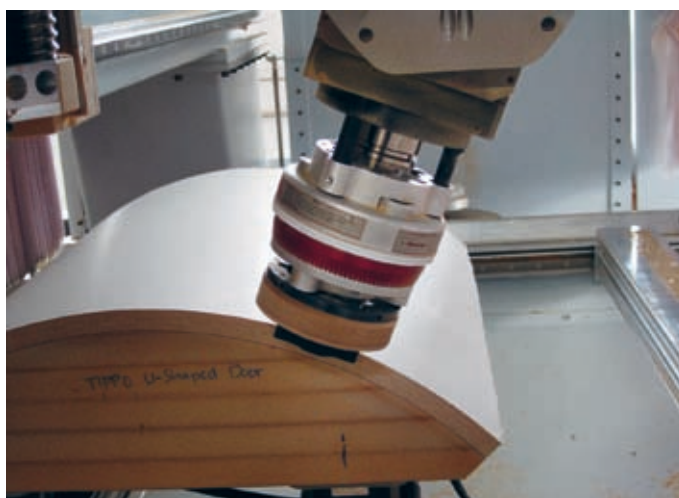
1 und 2: Das Tastaggregat fräst Radien in die Kanten der geschwungenen Formholzteile
